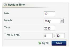
Synchronisieren zum Synchronisieren der AWI-Zeiteinstellungen mit Zeiteinstellungen aller verbundenen Graco-Geräte klicken. Auf Synchronisieren-Bildschirm aktuelle Zeit bestätigen. Wenn korrekt, Synchronisieren klicken. Wenn inkorrekt, Abbrechen klicken, um zum Einstellungen-Reiter zurückzukehren und Korrekturen vorzunehmen.
