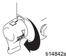
10. Plongez la pompe dans un seau métallique mis à la terre et rempli en partie de liquide de rinçage. Fixez le fil de terre sur le seau et sur une véritable terre. Effectuez les opérations 1 à 5 de la rubrique **Démarrage** pour nettoyer le pulvérisateur de l'huile d'entreposage laissée à l'intérieur. Rincez à l'eau pour éliminer la peinture à base aqueuse et au white-spirit pour éliminer la peinture à l'huile et l'huile d'entreposage.
