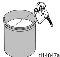
7. Das Entlüftungsventil nach unten auf die DRAIN-Position drehen und die Spülflüssigkeit zirkulieren lassen, bis sie klar aussieht.
