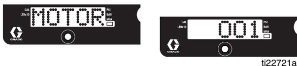
5. Premere rapidamente il pulsante DTS. Il messaggio **LAST ERROR CODE** (Ultimo codice di errore) scorre e viene visualizzato l'ultimo codice di errore; es. **E=07**. Vedere il manuale di riparazione dello spruzzatore per ulteriori informazioni.
