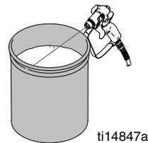
7. Ruotare la valvola di adescamento sulla posizione di SCARICO e permettere al fluido di lavaggio di circolare fino a che il fluido stesso non diventa pulito.
