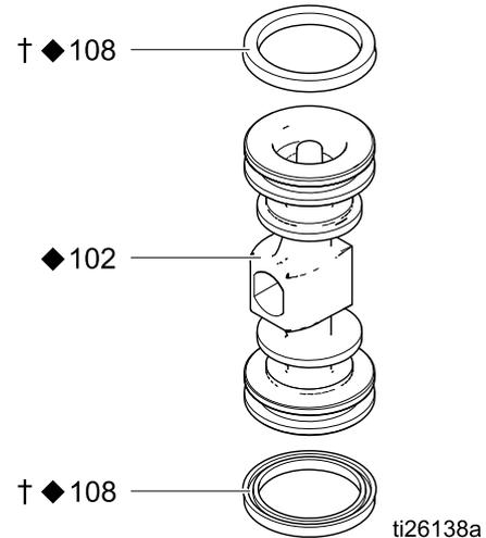
4. Engrase ambos extremos del pistón (102) y móntelo en el alojamiento (101), con el lado plano hacia la copela. Tenga cuidado de no romper las copelas en U (108) cuando deslice el pistón en el alojamiento.
