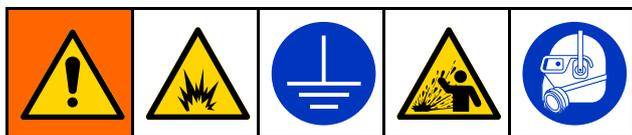
Para evitar incendios y explosiones conecte siempre a tierra el equipo y el contenedor de residuos. Para evitar lesiones por salpicaduras o por electricidad estática, lave siempre con la presión más baja posible.
