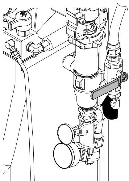
9. Nastavte ventily VYPOUŠTĚNÍ TLAKU / STŘÍKÁNÍ do polohy STŘÍKÁNÍ a odstraňte z vypouštěcího potrubí vlhkost.
