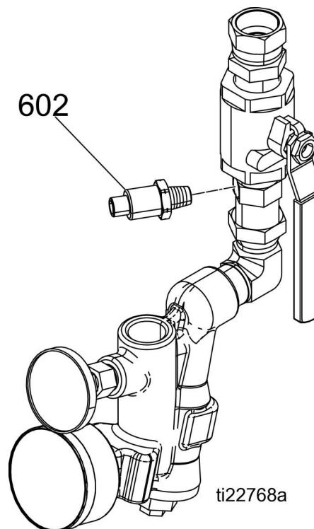
OBR. 6: Vstupní snímač kapaliny
