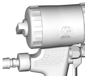
8. Odpojte vzduchové potrubí pistole a vyjměte rozdělovač kapaliny pistole.
