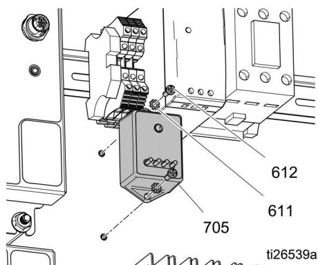
OBR. 19: Svodič přepětí
