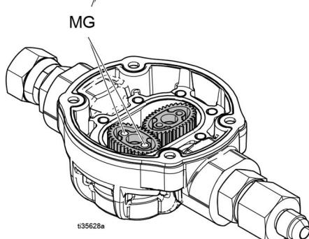
**POZNÁMKA:** Převodová kola s magnety (MG) musí být instalována na levé straně, jinak měřicí přístroj nebude pracovat. Namontujte převodová kola způsobem znázorněným na obrázku.
