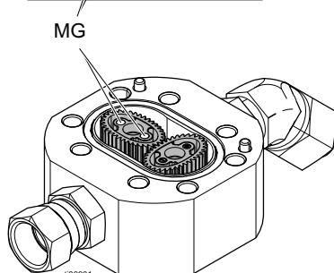
**POZNÁMKA:** Převodová kola s magnety (G) musí být instalována na levé straně, jinak měřicí přístroj nebude pracovat. Namontujte převodová kola způsobem znázorněným na obrázku.
