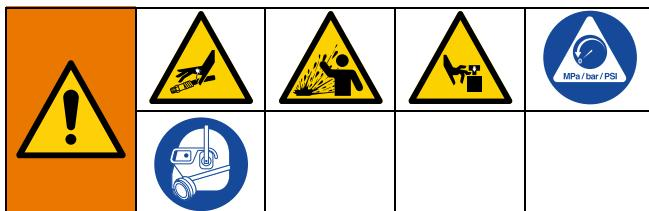
Zařízení zůstává pod tlakem, dokud nedojde k ručnímu uvolnění tlaku. Abyste pomohli zabránit vážnému zranění natlakovanou kapalinou, například vstříknutí pod kůži, výstřikem kapaliny a pohyblivých částí, postupujte podle pokynů uvedených v části Postup uvolnění tlaku, kdykoli přestanete stříkat a před čištěním, kontrolou a údržbou zařízení.
