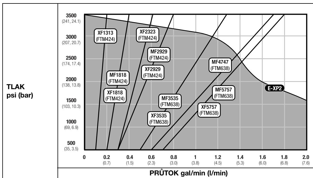
**POZNÁMKA:** Křivky výkonnosti elektrických jednotek jsou založeny na obvyklých provozních podmínkách. Dlouhodobé nepřetržité stříkání nebo vysoká okolní teplota snižují výkonnostní profil.
