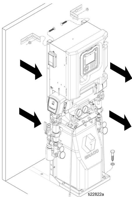
9. Demontujte dva šrouby a matice a sklopte elektrickou skříň dozadu.
