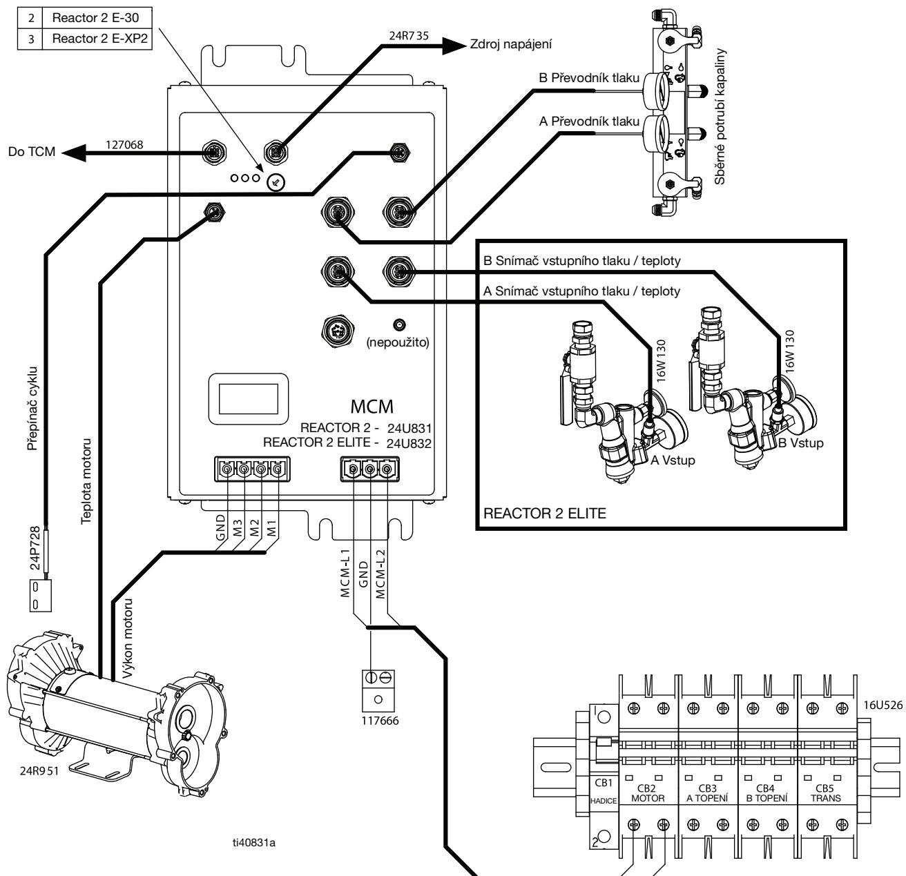
Schémata elektrického zapojení
