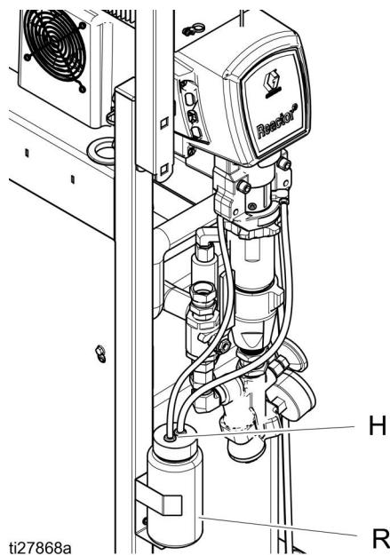
7. Zkontrolujte, zda čerpadlo ISO funguje správně, zjištěním pulsování ve zpětném potrubí při normálním provozu čerpadla dávkovače.
