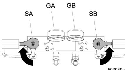
Chcete-li propláchnout celý systém, spusťte cirkulaci sběrným kapalinovým potrubím pistole (se sběrným potrubím sejmutým z pistole).
