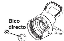
Se notar uma fuga de produto na parte dianteira da pistola, substitua o encaixe (33a) e/ou volte a apertar a porca do protector.
