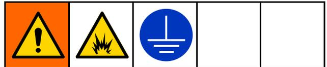
L'apparecchiatura deve essere collegata a terra per ridurre il rischio di scintille statiche. Le scintille statiche possono provocare l'accensione o l'esplosione di fumi. La messa a terra fornisce un filo di fuga per la corrente elettrica.
