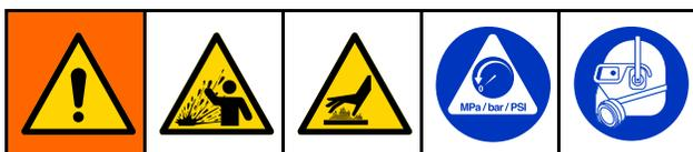
本装置は、圧力が手動で解放されるまでは、加圧状態が続きます。皮膚や目などへの飛散など、加圧状態の液体から生じる重大な怪我を避けるには、ポンプの動作を止めた後および装置を清掃、点検、および整備する前に、圧力開放手順に従ってください。
