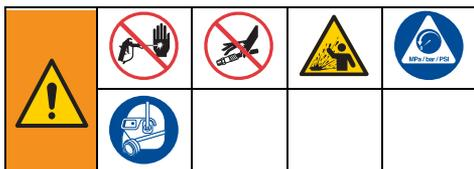
Cet équipement reste sous pression jusqu'à ce que la pression soit relâchée manuellement. Pour éviter de sérieuses blessures provoquées par du fluide sous pression, comme des injections sous-cutanées, des projections de produit ou pièces en mouvement, suivez la Procédure de décompression à chaque fois que le pulvérisateur est arrêté et avant le nettoyage ou la vérification du pulvérisateur, et avant que l'équipement a fait l'objet d'une réparation.
