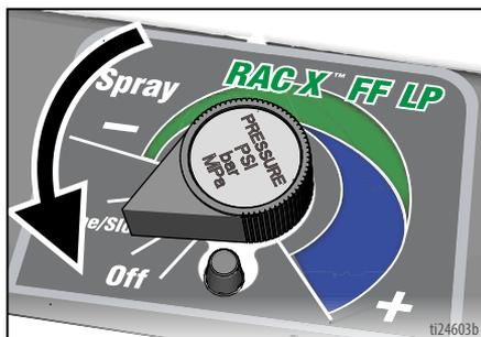
4. Mantenere una parte metallica della pistola a contatto con un secchio metallico collegato a terra. Azionare la pistola per rilasciare la pressione.
