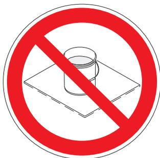
**Collegare sempre a terra un secchio metallico:** collegare un filo di terra al secchio. Bloccare un'estremità al secchio e l'altra a una messa a terra efficace quale un tubo dell'acqua.
