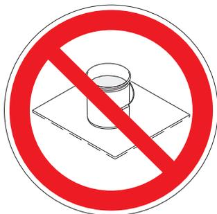
**Ligue sempre um balde metálico à terra:** ligue um fio de ligação à terra ao balde. Fixe uma extremidade ao balde e a outra a uma ligação efetiva à terra, tal como um tubo de água.
