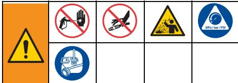
Ova oprema ostaje pod tlakom dok se tlak ručno ne otpusti. Kako bi spriječili teške ozljede od tekućine pod tlakom, poput infekcije kože, prskanja tekućinom i pokretnih dijelova, slijedite **postupak za otpuštanje tlaka** svaki put kada se raspršivač zaustavi i prije čišćenja ili provjere te prije servisiranja opreme.
