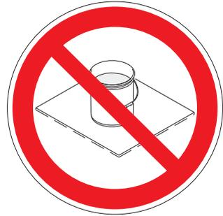
**Collegare sempre a terra un secchio metallico:** collegare un filo di terra al secchio. Bloccare un'estremità al secchio e l'altra a una messa a terra efficace quale un tubo dell'acqua.
