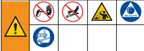
本装置は、圧力が手で開放されるまでは、加圧状態が続きます。スプレーヤーを停止させたとき、皮膚への侵入、液体の拡散、可動部品など、高圧液体による深刻な損傷を受けないようにするには、スプレーヤーの洗浄または点検を行う前に、および装置のメンテナンスを行う前に**圧力解放手順**を実施します。
