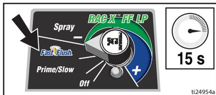
6. プライムバルブを水平にします。引き金ロックを解除します。
