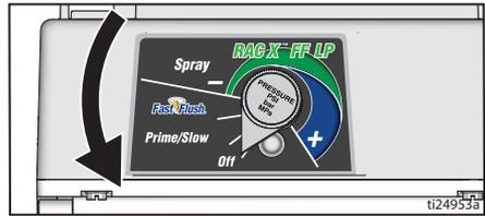
4. 接地した金属缶にガンの金属部分をしっかりと接触させます。ガンをトリガーして圧力を開放します。
