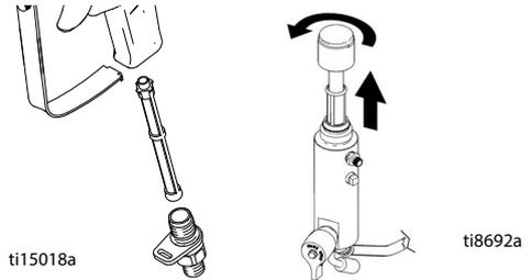
10. 根据型号，要么取下吸管底部的螺母和入口过滤器，要么旋松并取下入口过滤器。若有必要可更换过滤器。重新装好。
