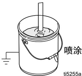
13. 再次朝冲洗液桶内扣动喷枪扳机，直到有涂料流出。
