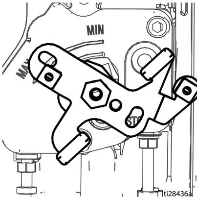
7. 将液压泵阀置于接通位置（液压电动机当前处于工作状态）。
