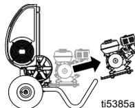
3. 倾斜发动机 / 马达。安装发动机 / 马达。装上皮带。降下皮带护罩。
