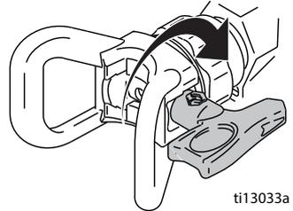
2. 锁上扳机锁。将 SwitchTip 旋转到原始位置。松开扳机锁，继续喷涂。
