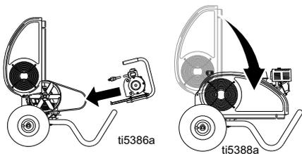
4. 旋转马达夹。拧紧马达夹和皮带护罩旋钮
