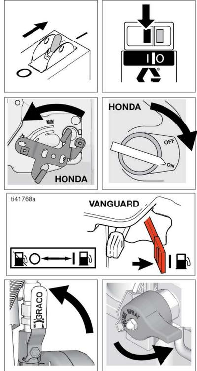
5. 将喷枪靠在料桶上。松开扳机锁。转动压力控制旋钮以增大压力，直到电动机开始驱动泵运行。扣动喷枪扳机直到有冲洗液流出。
