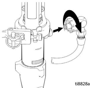
5. 滑动耦合器盖，直到完全露出活塞柱耦合器。
