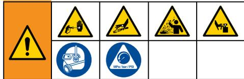
本设备在手动释放压力之前一直处于加压状态。为防止加压流体（如喷射到皮肤、流体飞溅和零部件移动）带来的重伤，在停止喷涂时和清洗、检查或维修设备前，请遵照泄压步骤执行操作。
