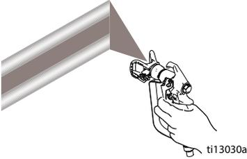
2. 握住喷枪，使其垂直于被喷表面并距离 10-12 英寸 (25-30 cm)。来回喷涂。重叠 50%。在移动后扣动喷枪并在停止前释放扳机。
