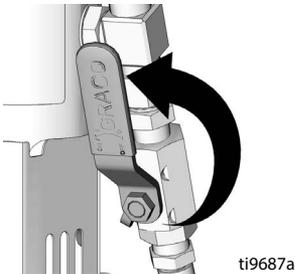
8. 将压力增大至足以使液压马达起动运行，然后让流体循环 15 秒钟；将压力降低并将填料阀旋至水平位置。
