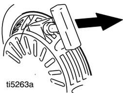
f. 发动机启动后，将阻风门推到打开位置。
