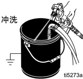
7. 在继续扣动喷枪扳机的同时将填料阀向下旋转。然后释放喷枪扳机。让冲洗液循环，直至从排放管流出的流体变清为止。
