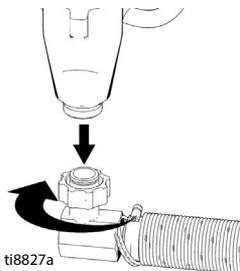
4. 从泵管接头上拆下涂料软管接头和涂料软管。
