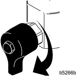
8. 将吸料管提升到冲洗液的液面之上并运行喷涂机 15 至 30 秒钟，以将流体排出。关闭液泵压泵阀。关闭发动机或关闭电动机，拔掉插头。
