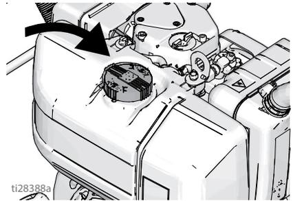
10. 检查液压油位。参阅第 25 页，了解液压油规格。添加液压油直至油位介于 MIN 和 MAX 之间（冷却时的安全范围）。液压油箱容量为 5 夸脱（4.75 升）。
