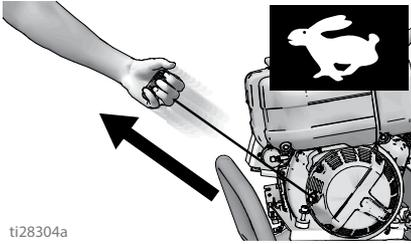
e. 发动机启动后，将油门杆拨至“MAX（最大）”（全开）位置。
