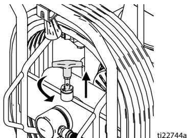
3. 向下拉卷盘手柄并顺时针旋转以卷绕软管。
