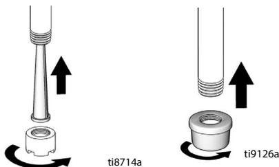
6. 当喷涂表面纹理时，请移除入口过滤器和滤杯筛网。
