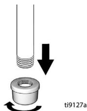
7. 给喉部密封螺母注满喉管密封液（TSL），以防止密封件过早磨损。每次喷涂时都要这样做。
