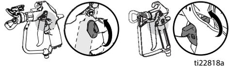
10. 握住喷枪靠在接地的金属冲洗桶上。扣动喷枪扳机并缓慢增大流体压力，直到泵运行平稳为止。释放扳机，让喷涂机憋压。锁上扳机锁。
