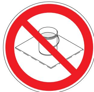
**Uvijek uzemljite metalnu posudu:** spojite vodič za uzemljenje na metalnu posudu. Jedan kraj spojite na vjedro, a drugi na uzemljenje, primjerice vodovodnu cijev.
