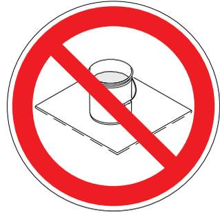
**Collegare sempre a terra un secchio metallico:** collegare un filo di messa a terra al secchio. Bloccare un'estremità al secchio e l'altra a una messa a terra efficace, come un tubo dell'acqua.
