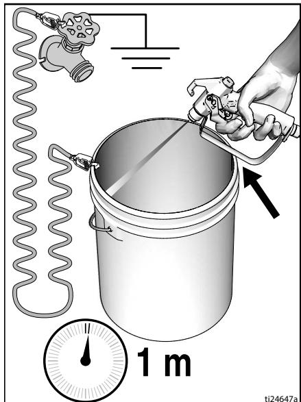
8. 将喷枪移向涂料桶并扣动扳机 20 秒钟。释放扳机，让喷涂机憋压。锁上扳机锁。
