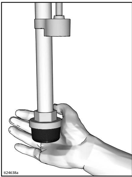
7. 给喉部密封螺母注满喉管密封液（TSL），以防止密封件过早磨损。每天或每次喷涂时执行此操作。
