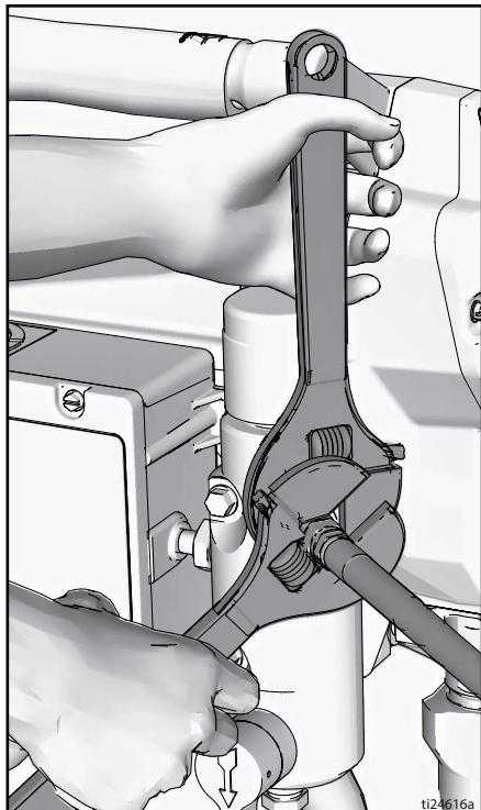
2. 将软管的另一端连接到喷枪上。
