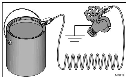
**为在冲洗喷涂机或泄压时保证持续接地：** 将喷枪的金属部分牢牢固定至接地金属料桶的一边，然后启动喷枪。
