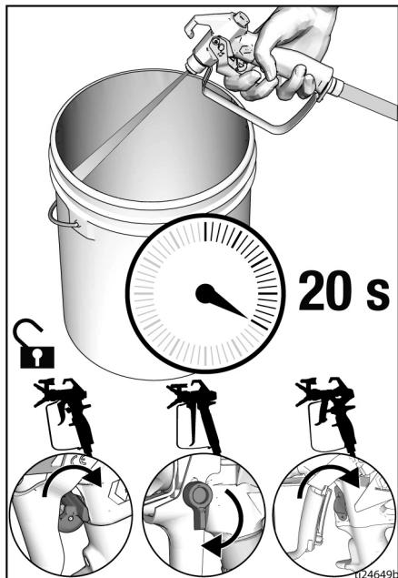
9. 检查无气软管和软管连接是否存在泄漏。如果发生泄漏，请按照 **泄压步骤**，页面 12 进行操作，然后拧紧所有管件，并重复启动程序。如果没有泄漏，继续下一步，**操作**，页面 19。
