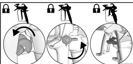
3. 将压力控制调到最低。松开扳机锁。
