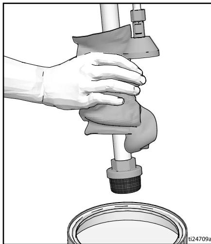
4. 将吸料管放入冲洗液中。水性涂料用水, 油性涂料用矿物油精。将排放管放入废液料桶中。
