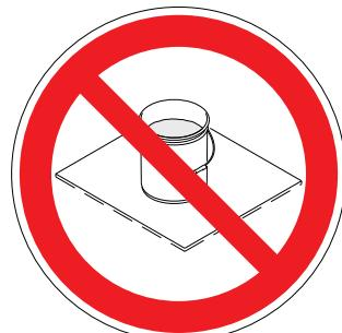
**始终将金属料桶接地：** 将接地线连接到料桶上。将一端夹在料桶上，将另一端夹在真正的接地带，例如水管上。
