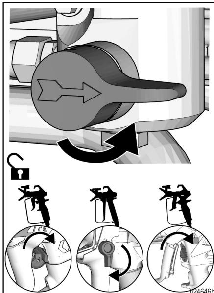
16. 将喷枪的金属部分紧紧靠在接地的金属料桶上。扣动喷枪扳机, 直到冲洗干净。
