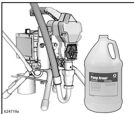
15. 用一块在水或矿物油精中浸泡过的抹布擦洗喷涂机、软管及喷枪。
