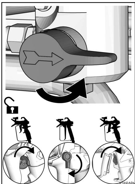
16. 接地されたペール缶にガンの金属部分をしっかりと接触させます。ガンの引き金を引いて、出てくる液体がきれいになるまで洗浄します。
