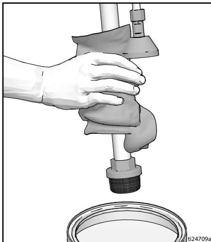
4. 液体吸入口を洗浄液の中に入れます。水性塗料の場合には水を、油性塗料の場合にはミネラルスピリットを使用します。排出チューブを廃液ペール缶の中に入れます。
