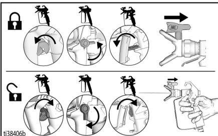
2. 引き金ロックを掛けます。スプレー チップを元の位置に戻します。引き金 ロックを解除して噴射を続行します。
