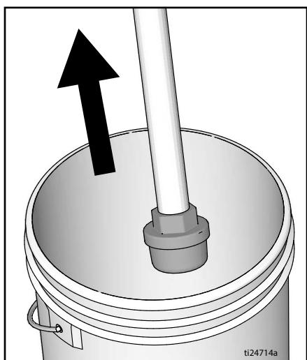
10. プライムバルブを水平にします。洗浄用ペール缶に向けてガンの引き金を 20 秒間引き、ホース内の液体を排出します。
