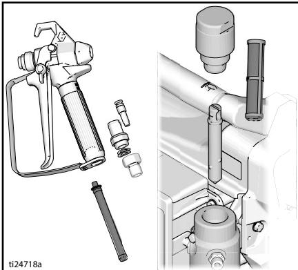
14. 水で洗浄した場合には、ミネラルスピリットでもう一度洗浄します。または PumpArmor で洗浄して、凍結や腐食を防止するための保護コーティングが残るようにします。
