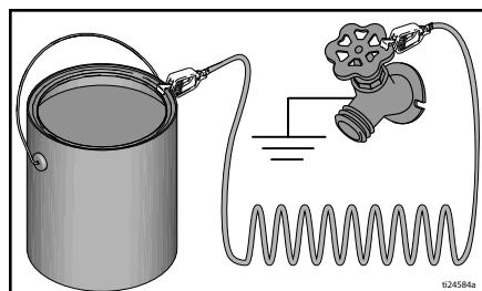
スプレーヤーを洗浄したり、圧力を解放しているときに、接地を維持するために、スプレーガンの金属部分を接地された金属製ペール缶の側面に向けてしまつて、ガンの引き金を引きます。
