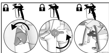
3. 圧力コントロールを最低設定まで回します。引き金ロックを解除します。
