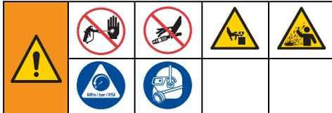
Cet équipement reste sous pression jusqu'à ce que la pression soit relâchée manuellement. Pour prévenir les blessures graves causées par les liquides sous pression, telles que les injections cutanées, les éclaboussures et les pièces en mouvement, suivez la **Procédure de décompression** chaque fois que le pulvérisateur est arrêté et avant que le pulvérisateur ne soit nettoyé ou vérifié, et avant l'entretien de l'équipement.
