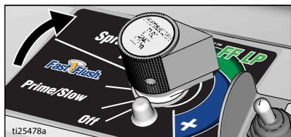
5. Réduisez la pression produit jusqu'à l'apparition de cornes dans la forme du jet.
