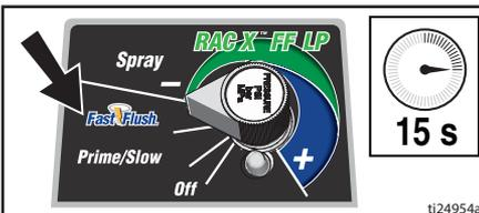
6. Mettez la vanne d'amorçage en position horizontale. Déverrouillez la gâchette.
