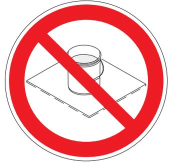
**Reliez toujours un seau métallique à la terre :** raccordez un câble de terre au seau. Serrez une extrémité au seau et l'autre extrémité à une vraie prise de terre telle qu'un conduit d'eau.
