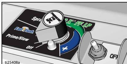
4. Плотно прижмите металлическую часть пистолета к заземленной металлической емкости. Нажмите пусковой курок пистолета, чтобы снять давление.
