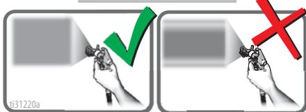
Распыление с равномерно распределенным веером распыла
