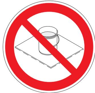
**Всегда заземляйте металлическую емкость.** Подсоедините к емкости провод заземления. Подсоедините один конец к емкости с помощью зажима, а второй – к точке истинного заземления, например к трубе для подачи воды.
