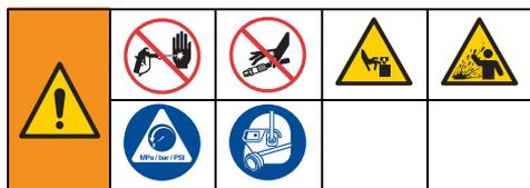
Это оборудование будет оставаться под давлением до тех пор, пока давление не будет снято вручную. Во избежание получения серьезной травмы, вызванной жидкостью под давлением (например, в результате прокола кожи, разбрызгивания жидкости и контакта с движущимися деталями), выполняйте **процедуру снятия давления** после каждого завершения работы распылителя и перед очисткой, проверкой либо обслуживанием оборудования.
