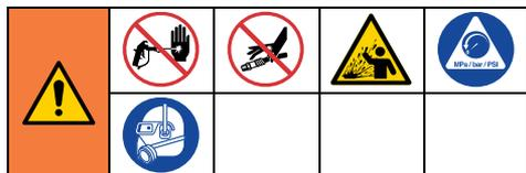
Este equipo seguirá presurizado hasta que se libere manualmente la presión. Para evitar lesiones graves debido al fluido presurizado, como la inyección en la piel, salpicaduras de fluido y las ocasionadas por piezas en movimiento, siga el **Procedimiento de descompresión** cuando deje de pulverizar y antes de limpiar, revisar o realizar el mantenimiento del equipo.
