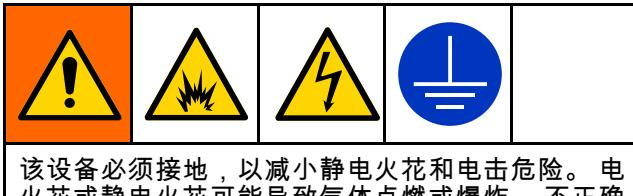
该设备必须接地，以减小静电火花和电击危险。电火花或静电火花可能导致气体点燃或爆炸。不正确的接地可导致触电。接地为电流提供逃逸通路。
