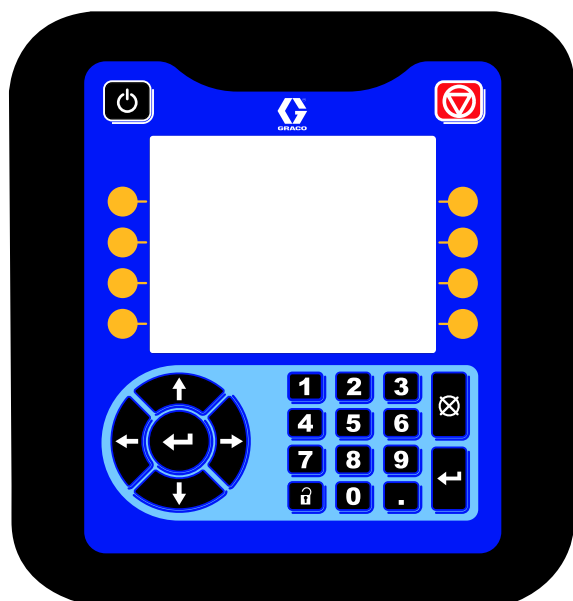
Figure 5 Блок управления с дисплеем (ADM), вид спереди
