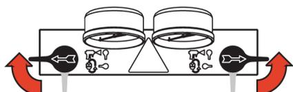
4. Drücken Sie
