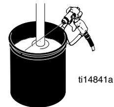
4. Coloque el tubo de drenaje en el bote. Gire la válvula de cebado hacia abajo en la posición de DRENAJE.
