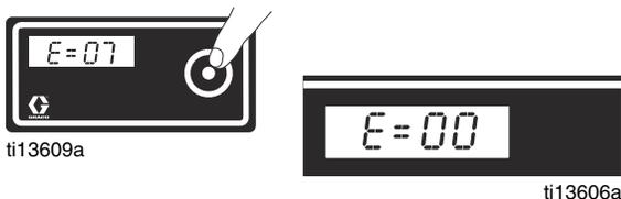
7. Pulse brevemente el botón DTS. Se visualiza brevemente **W-DOG** y luego aparece **OFF** si el interruptor Watchdog está apagado. Aparece **ON** si el interruptor Watchdog está encendido.
