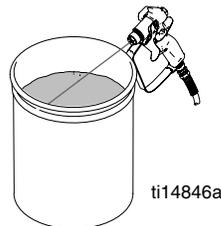
4. Mueva la pistola hasta el bote de basura, apunte la pistola hacia el bote y presione el gatillo hasta enjuagar completamente el sistema. Suelte el gatillo y bloquéelo.
