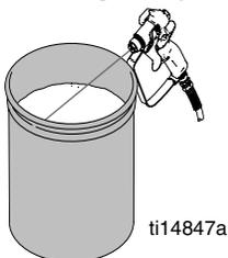
5. Coloque la válvula de cebado en la posición de **DRENAJE** y permita que el fluido de enjuague circule hasta que salga limpio.
