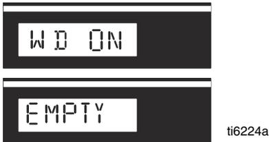
3. Apague el interruptor WatchDog. Agregue material o vuelva a cebar el pulverizador. Apague y encienda el interruptor de la bomba para restablecer el sistema de protección WatchDog. Encienda nuevamente el interruptor WatchDog para seguir controlando el nivel de material.
