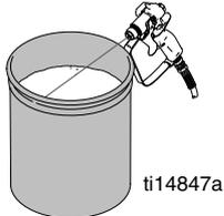
5. Das Entlüftungsventil in die **DRAIN-Position** drehen und Spülflüssigkeit zirkulieren lassen, bis sie klar aussieht.
