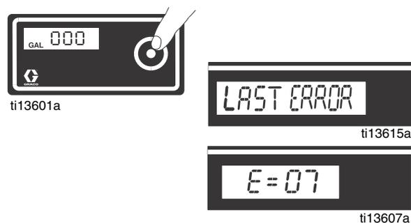
6. Die DTS-Taste gedrückt halten, um den Fehlercode zu löschen und auf Null zurückzusetzen.
