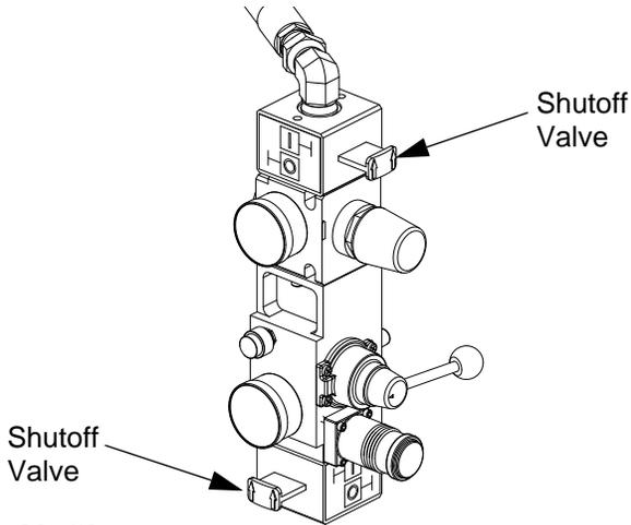
**Fig. 66: Close Shutoff Valves**
