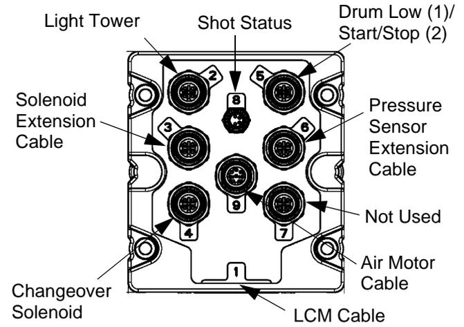
**FIG. 44: Breakout Module Connections**
