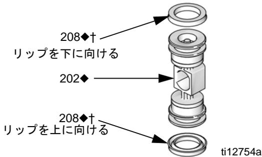
図 1. エアバルブUカップの取り付け
