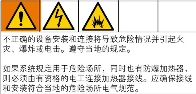
当使用防爆加热器时，应确保电线、电线接头、开关和电气配电板均符合防火（防爆）要求。
