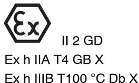
ATEX-Modelle mit Membranpumpen sind wie folgt klassifiziert:
