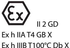
Модели ATEX с мембранными насосами имеют следующую классификацию:
