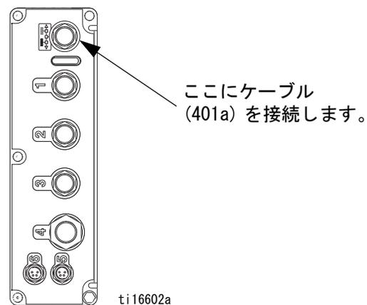
図 6. CAN ケーブルを再接続する。
