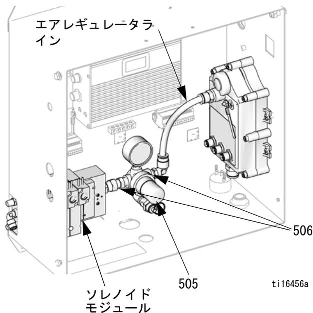
図 10. オルタネータレギュレータの交換
