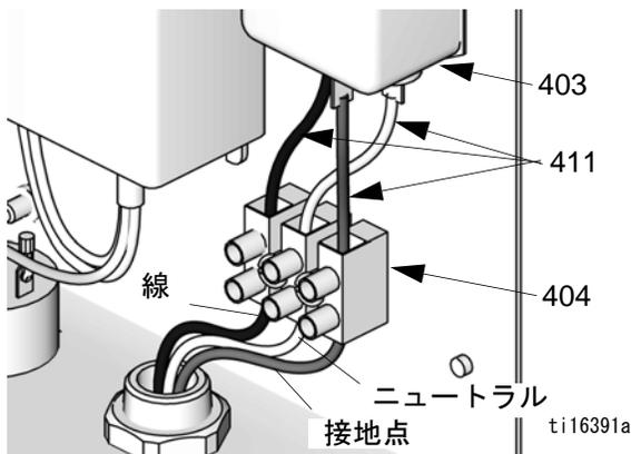
図 5. 端子ブロックの電気接続
