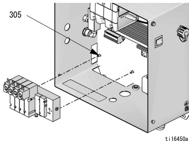
図 4. ソレノイドモジュールの交換
