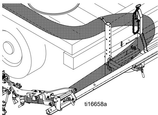
5. Postavite ruku pištolja na kraj klizne šipke i osigurajte snop crijeva na držać za podešavanje visine pomoći gumenog podmetača i obujmice crijeva (320).
