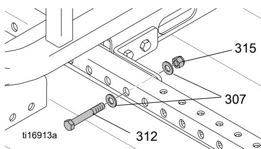
3. Instalirajte držač za podešavanje visine na montažne ruke sustava RoadPak (303).
