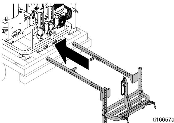
1. Spojite držače (316) na sustav RoadPak na četiri mesta s vijcima (312), podlošcima (307) i maticama (315). Bilo bi idealno smjestiti držače što dalje jedan od drugoga kako bi se omogućila optimalna potpora. Montažna lokacija držača ovisit će o mjestu montaže sustava RoadPak na vozilo.
