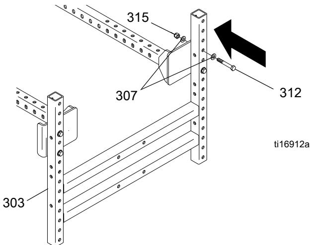
**NAPOMENA:** Preporuča se spojiti montažni držač vijcima kroz platformu na okvir vozila.
