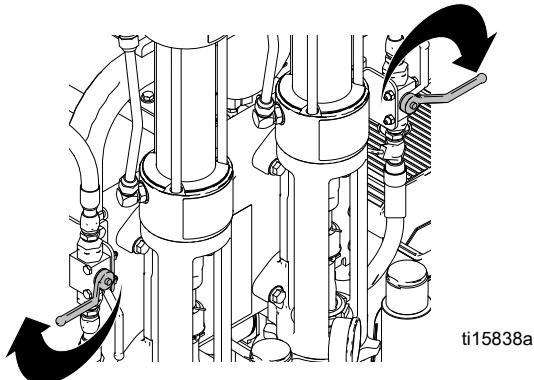
3. Posudu od 5 galona napunite vodom ili kompatibilnim otapalom. Usisno crijevo za boju postavite u posudu.
