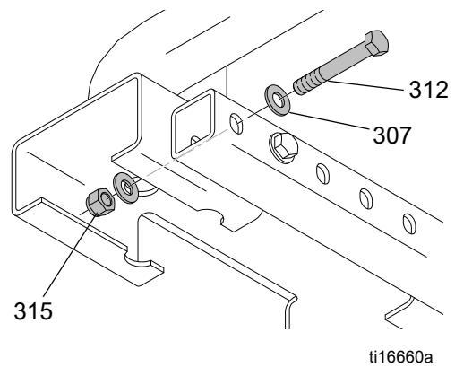
4. Instalirajte držač za podešavanje visine (303) na montažne ruke sustava RoadPak (304) s vijcima (312), podlošcima (307) i maticama (315).
