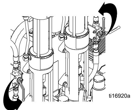
15. Kada voda/otapalo počne izlaziti iz pištolja za prskanje, postavite hidraulični ventil na položaj isključeno.
