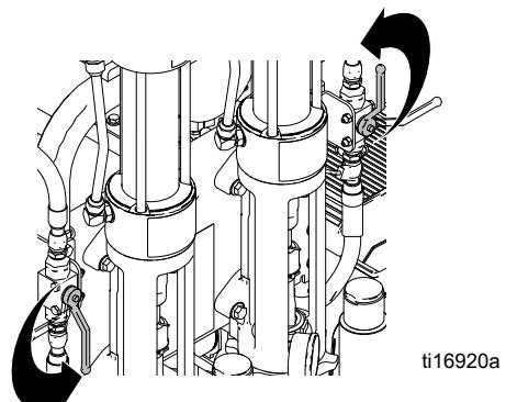
9. Kada voda/otapalo počne izlaziti iz pištolja za prskanje, postavite hidraulični ventil na položaj isključeno.
