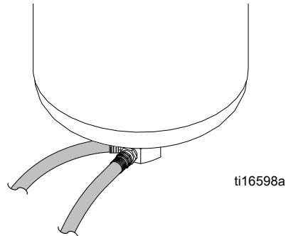
5. Instalirajte crijevo za zrak na priključak za brzo spajanje na spremniku za zrak.
