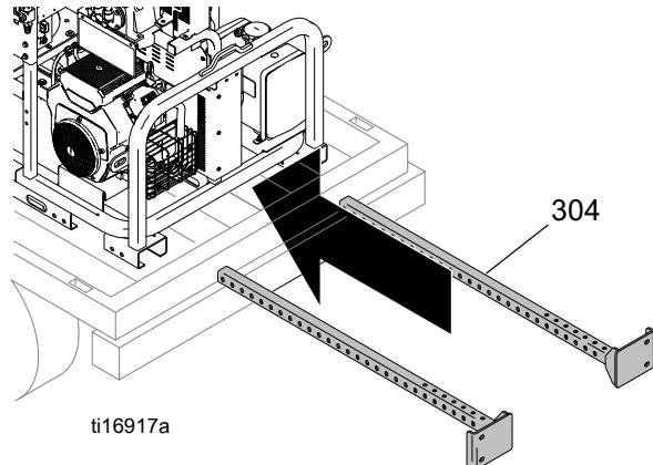
2. Ovisno o tome gdje se sustav RoadPak nalazi na vozilu određuje se koje otvore treba vijcima spojiti na okvir sustava RoadPak. Postoji 8 mogućih montažnih otvora za svaku montažnu ruku. Zategnite vijke barem na dva otvora sa svake strane.
