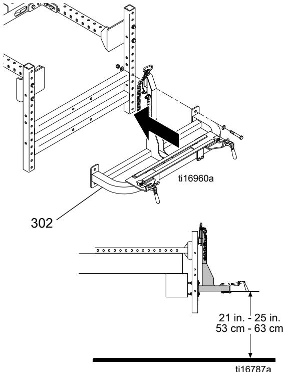
**NAPOMENA:** Preporuča se spojiti montažni držać vijcima kroz platformu na okvir vozila.
