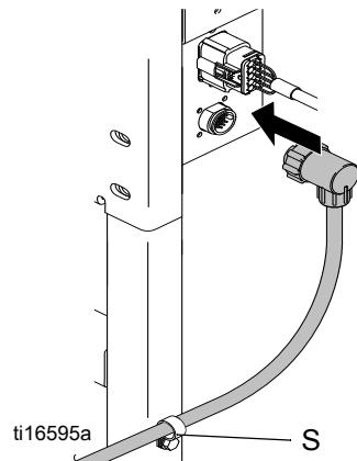
3. Položite upravljački kabel na kabinu vozila bez uklještenja kabela. Spojite kabel na upravljačku kutiju. Položite kabel kroz obujmicu kabela radi otpuštanja naprezanja na spoju.
