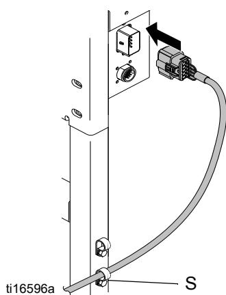
2. Spojite upravljački kabel na razdjelnu kutiju. Zategnite kabel na obujmicu kabela radi otpuštanja naprezanja (S) na spoju.
