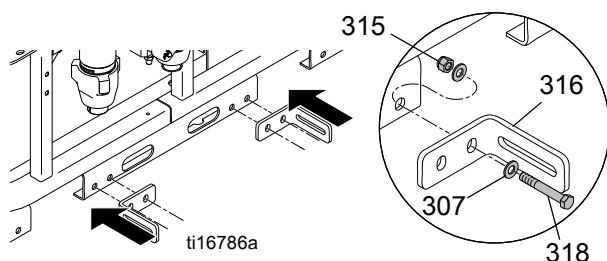
2. Umetnите montažne držače sustava RoadPak (304) kroz izrezane otvore u okviru i rukom zategnite montažne ruke na držače s vijcima (312), podlošcima (307) i maticama (315).
