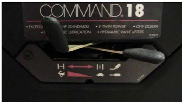
4. Quando il motore è stato avviato, impostare la valvola dell'aria su OFF.
