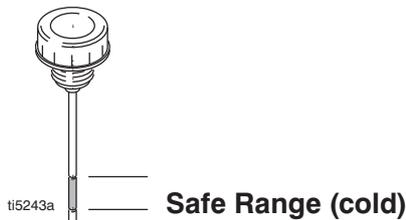
6. Controllare il livello dell'olio nel compressore.
