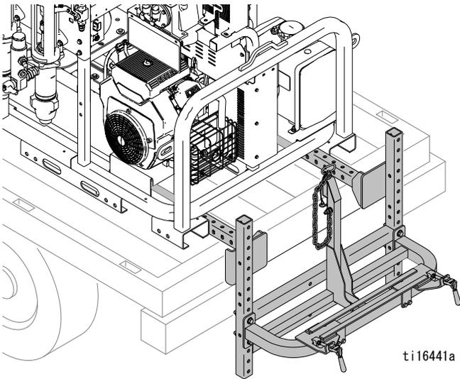
注：以下の取り付け技術に加え、RoadPak の取り付けアームを切り、荷台を通して車両のフレームにボルト付けるオプションがあります。
