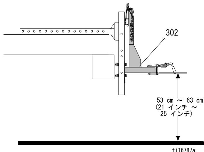
**注：** 取り付け用ブラケットを車両のベッドを通して、車両のフレームにボルトけします。
