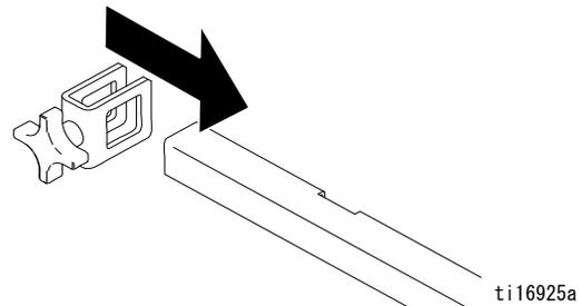
7. インジケータースライド (362) を誘導延長アーム (352) に挿入し、ノブ (354) で固定します。
