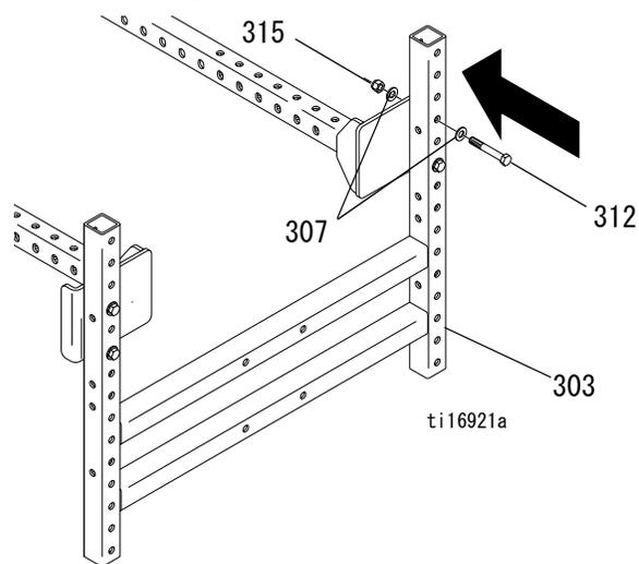
4. 設置位置に固定するために、レンチを使用してすべてのボルトを締めます (トルク 38.0 N-m (28 フィートポンド) まで)。
