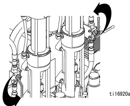
9. 水 / 溶液がスプレーガンから出たら、水圧バルブをオフ位置にセットします。
