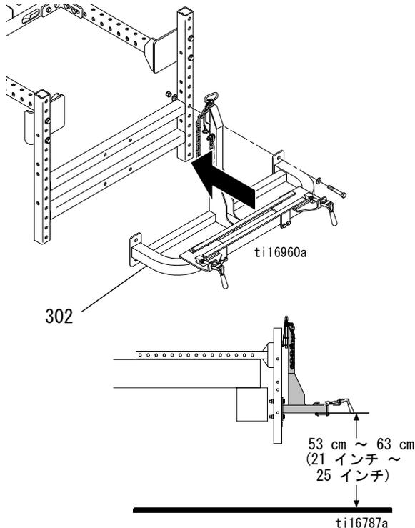
注：取り付け用ブラケットを車両のベッドを通して、車両のフレームにボルトけします。
