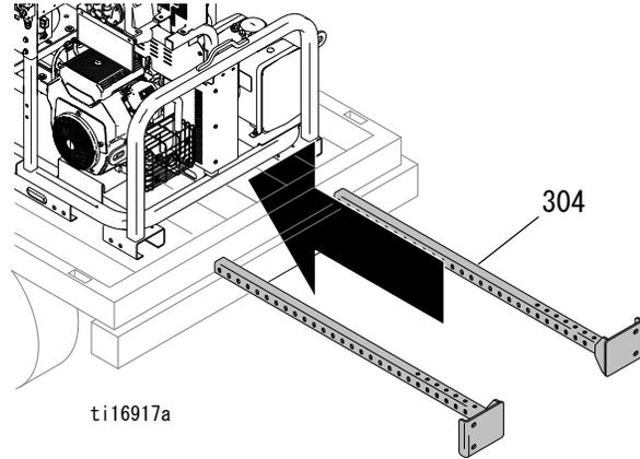
2. RoadPak の車両での位置によって、RoadPak のフレームでどの穴を通してボルト付けするか決定されます。各取り付けアームにつき 8 か所の使用可能な取り付け穴があります。両側とも少なくとも 2 つ穴に固定してください。
