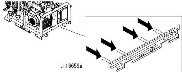
3. マウントにボルト (312)、ナット (315)、およびワッシャー (307) を手で締めます。
