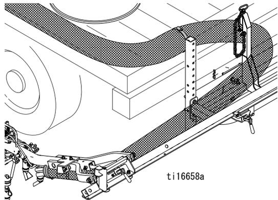
2. ガンアームを収容位置に持ち上げます。スライドビームを車両の反対側に引き出し、ガンアームをそちら側に引っ張り、完全な動作ができるようにホースの長さが十分であることを確認してください。
