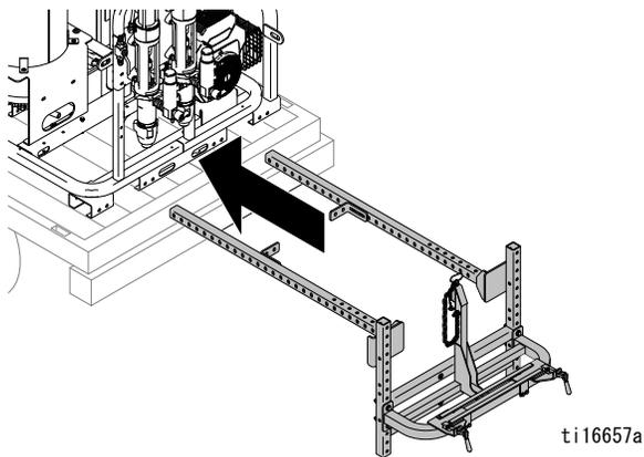
1. ボルト (312)、ワッシャ (307)、およびナット (315) でブラケット (316) を RoadPak に 4 か所ボルト付けします。最適なサポートを提供するために、できる限りにブラケット同士を離れた場所に設置するのが理想的です。ブラケットの取り付け場所は、RoadPak の車両に取り付けられる位置によります。
