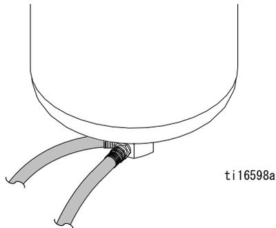
5. エアホースをエアタンクのクイック接続の取り付け金具に取り付けます。
