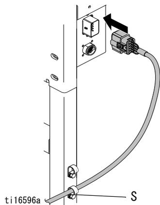
3. ケーブルを折り曲げずに、コントロールケーブルを車両の運転室に取り回します。ケーブルをコントロールボックスに接続します。接続の張力緩和のために、ケーブルをケーブルクランプに通します。
