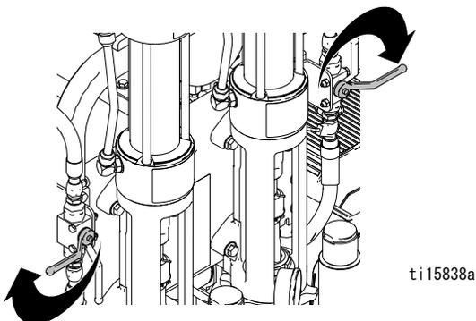
9. ガンの側にあるポンプレバーを時計回りに 1/4 回転させてオフ位置にします。
