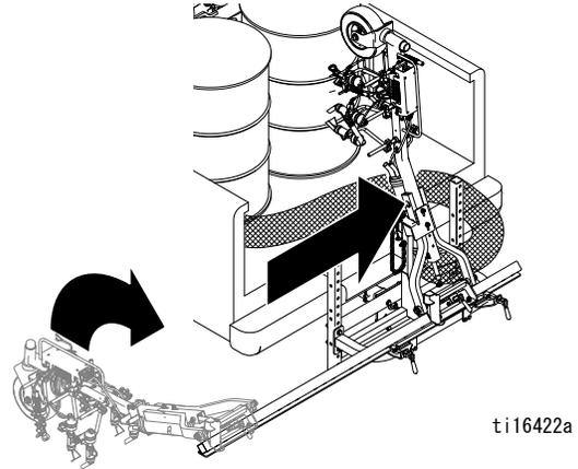
7. ガンアームを収容ブラケットの上に置き、収容ブラケットの上に乗るように適切に止め具の位置を合わせます。ピン (321) をガンアームのブラケットと収納ブラケットにスライドして通し、ガンアームを固定します。2 つのボルト (579) を締めて、ガンアームのブラケットを設置位置に固定します。
