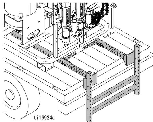
5. 収容ブラケット (302) を高さ調節ブラケット (303) に取り付けます。収容ブラケットの底面を地面から 53 cm ~ 63 cm (21 インチ ~ 25 インチ) の位置に合わせてください。収容ブラケットが水平に取り付けられていることを確認してください。
