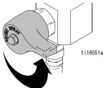
11. 塗料ポンプまたは使用される色に対応するスプレーガンのボールバルブのみを開けます。注：同時に 2 色のガンのバルブ両方を開けないでください。塗料色の汚染が起こる可能性があります。
