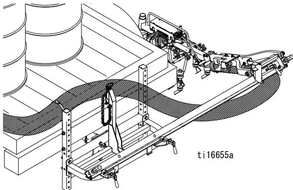
3. ガンアームを収容位置に戻し、ピンでその位置に押さえます。スライドビームを車両の中央に合わせます。スライドビームとガンアームそれぞれのクランプを締めることで、その位置に固定してください。
