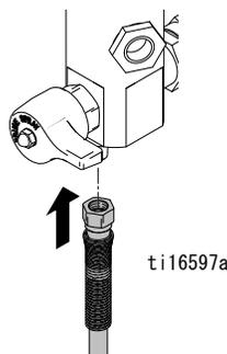
3. 塗料ラインを RPS 2900 フィルタアセンブリに取り付けます。2 色システムでは、塗料ガン 1 からポンプ 1 にホースを取り回し、塗料ガン 2 からポンプ 1 に 1 つのホースを取り回します。塗料ガン 2 からポンプ 2 に 2 つ目のホースを取り回します。
