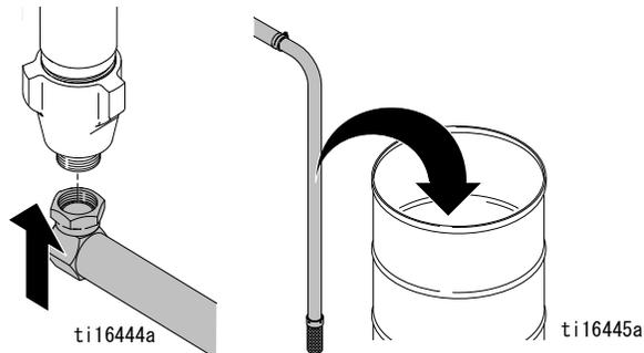
2. RPS 2900 フィルタアセンブリから戻りラインを取り付けて、塗料用ドラム缶に引き戻します。
