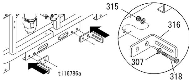
2. RoadPak 取り付けブラケット (304) をフレームの切り取られた穴に通してスライドし、取り付けアームをボルト (312)、ワッシャ (307)、およびナット (315) を手を使用してブラケットに締めます。
