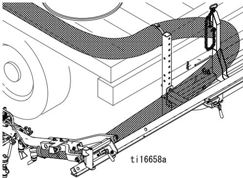
5. スライドビームの端にガンアームの位置を合わせ、ゴムパッドとホースクランプ (320) でホースバンドルを高さ調節ブラケットに固定してください。
