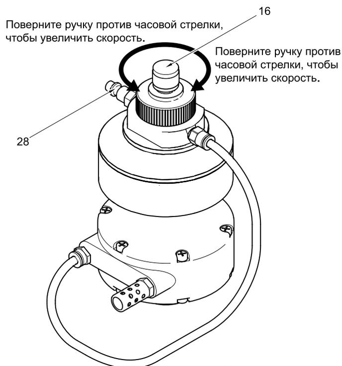
Чтобы выключить мешалку, отсоедините подачу воздуха или поворачивайте регулировочную ручку по часовой стрелке до упора.
