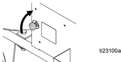
2. Feche a válvula de fecho manual da caldeira (KK) quando os queimadores estiverem frios. Feche a válvula de desligamento manual no tanque de propano quando terminar a fundição e o aquecimento do material termoplástico.
