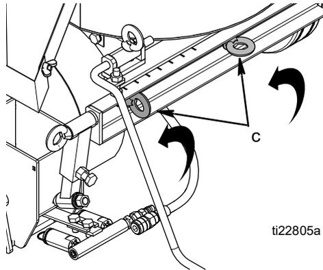
2. Deslize o suporte para a esquerda ou a direita até que a extremidade da estrutura esteja alinhada com as marcações pretendidas no suporte.
