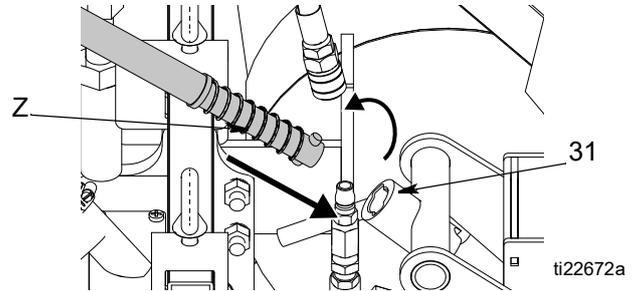
5. Ligue os dois tubos flexíveis de gás aos acoplamentos de libertação rápida (10).
