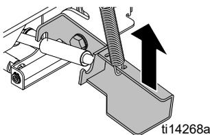
4. Alinhe o orifício da vareta do gancho de segurança com o orifício de ligação da caixa Screed e instale a chave do pino.
