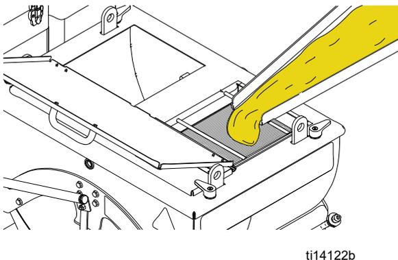
6. Mova o Actuador da Válvula (S) do ControlFlow para uma posição acima e preencha a caixa Screed com material termoplástico derretido.
