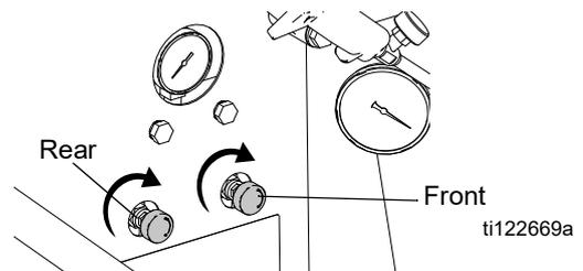
2. Retire os dois tubos flexíveis de gás dos acoplamentos de libertação rápida (10).
