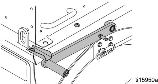
6. Carregue o saco de material termoplástico diretamente no trocador de calor da caldeira. Feche a tampa com as travas.
