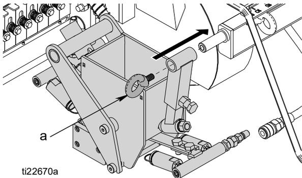
3. Volte a colocar e aperte o parafuso.
