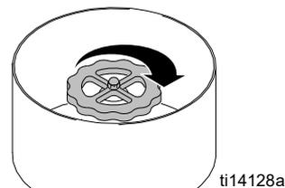
Use apenas a mão para primir ou girar a válvula de segurança de gás da caldeira (CC). Nunca use ferramentas. Se o botão não entrar ou girar manualmente, não tente repará-lo. Contacte um técnico qualificado. Uma tentativa de reparação ou de força pode causar explosão ou incêndio.
