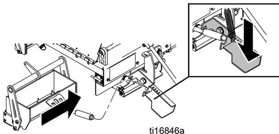
3. Encaixe a haste da caixa Screed na alavanca.
