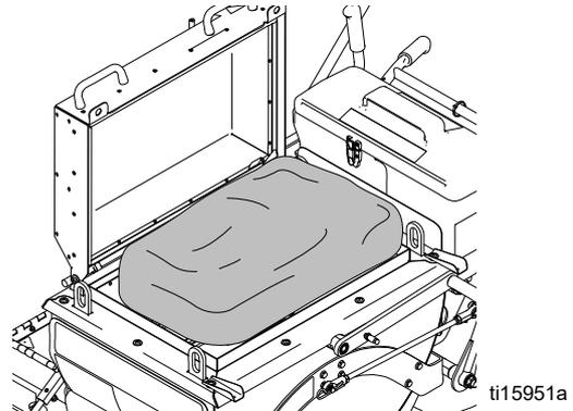
7. Agite o material termoplástico até que ele esteja completamente derretido. Para obter melhores resultados de agitação, use a manivela do agitador. Use a estrutura do actuador do agitador conectada para agitar o material termoplástico derretido.
