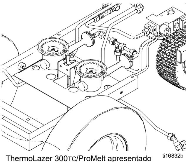
Os Queimadores da Caixa Screed Frontal e os Queimadores da Caixa Niveladora Traseira precisam ser acesos para testar as linhas de gás e adaptar o direcionamento da válvula de ajuste da chama.
