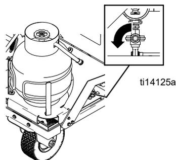
5. Desligue totalmente a chama do maçarico ajustando a válvula.
