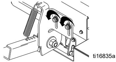
2. Deslize o suporte até que a beira principal do anel do molde da caixa Screed esteja fora da superfície. Para o melhor desempenho, eleve a frente principal em 0,020 pol. (0,5 mm) da superfície do solo. Uma faca raspadora pode ser usada para ajustar essa profundidade.
