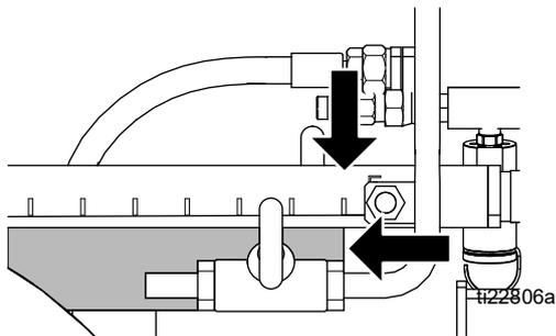
3. Aperte os parafusos do suporte de montagem da caixa.
