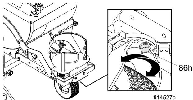
2. Rode a roda dianteira para a esquerda ou direita, conforme seja necessário, para a alinhar.
