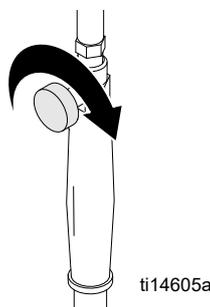
2. Feche a válvula de desligamento manual no tanque de propano quando terminar a fundição e o aquecimento do material termoplástico.
