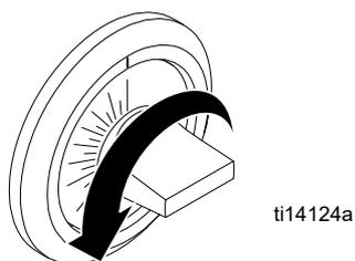
3. Feche totalmente a válvula de ajuste da chama do fluxo do queimador da Screed dianteira e traseira até OFF.
