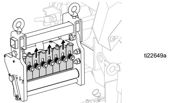
A proporção do fluxo do friso pode ser ajustada usando a Alavanca de Proporção de Fluxo no exterior da Caixa Distribuidora.
