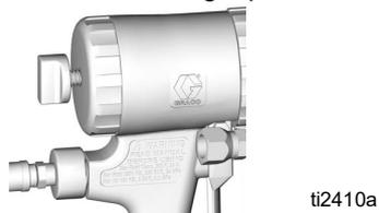
13. Zum Test ein Stück Pappe bespritzen. Den Druckluftregler so einstellen, um einen minimalen Materialdruck zu erhalten, der zu guten Ergebnissen beim Spritzbild führt.
