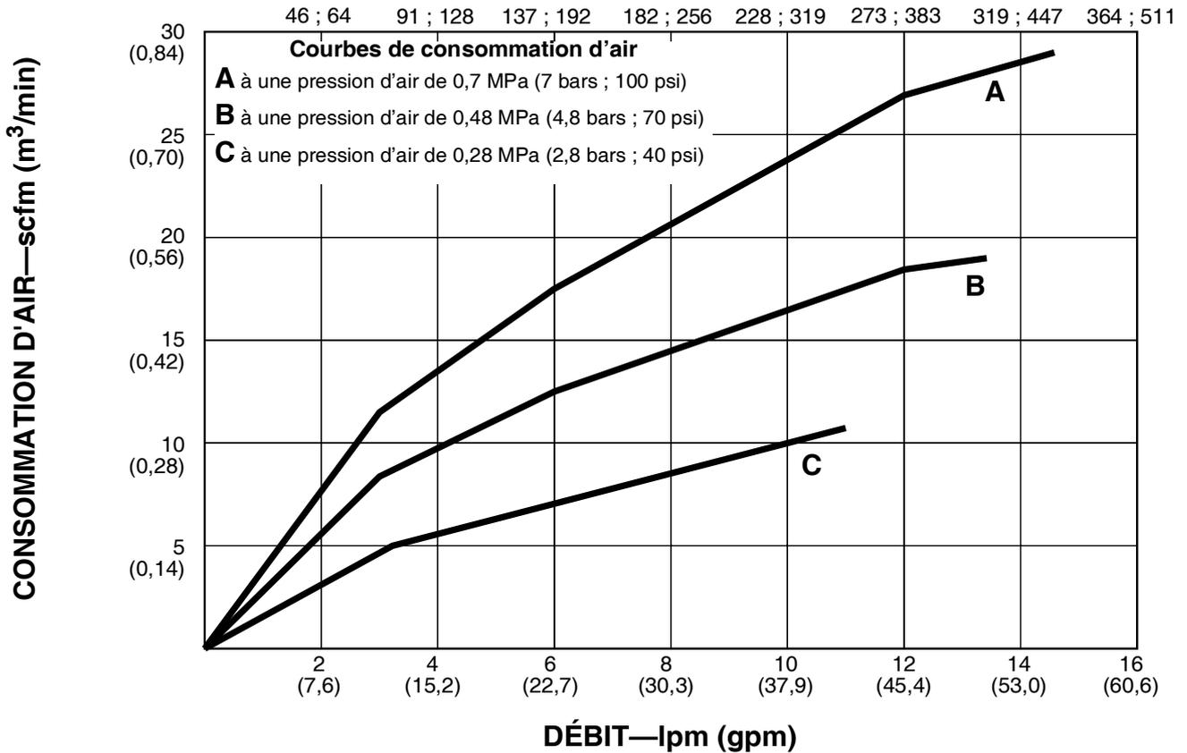
**Pour trouver la consommation d'air de la pompe (m<sup>3</sup>/min ou scfm) à un débit de produit spécifique (lpm/gpm) et une pression d'air spécifique (MPa/bars/psi) :**
