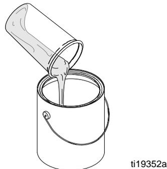
6. Setzen Sie eine neue Auskleidung in den Behälter ein und füllen Sie sie zu 1/2 mit geeigneter Spülflüssigkeit. Schrauben Sie den Deckel auf und bringen Sie den Behälter an das Spritzgerät an. Schütteln Sie das Spritzgerät, um die Spülflüssigkeit zu bewegen und alle befeuchteten Bereiche im Behälter zu reinigen.
