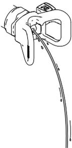
ti15528a | A válvula frontal está danificada ou gasta.                                       | Substitua a válvula frontal.                                           |
