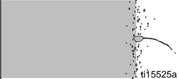
ti15525a                              | O material em excesso acumulou-se no Conjunto do Bico de Pulverização/ Protecção. | Consulte <b>Desactivação e Limpeza</b> , página 19.                    |
