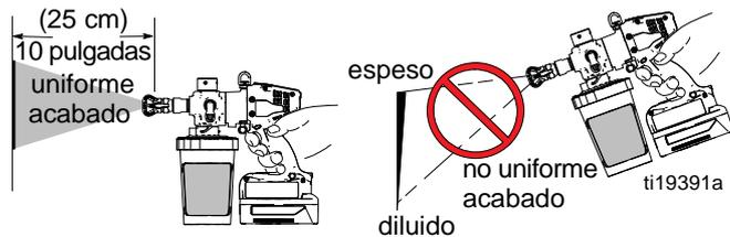
Flexione la muñeca para mantener la pulverizadora apuntada en forma recta. Mover la pulverizadora como un abanico para dirigir la pulverización en forma angulada producirá acabados no uniformes.
