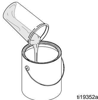
6. Coloque una nueva funda en el vaso y llene 1/2 con fluido de lavado apropiado. Enrosque la tapa y coloque el vaso en la pulverizadora. Sacuda la pulverizadora para hacer que el fluido de lavado circule y limpie todas las superficies húmedas dentro del vaso.
