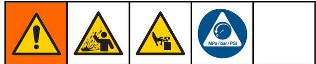
Este equipo seguirá presurizado hasta que se libere manualmente la presión. Para ayudar a evitar lesiones graves por salpicaduras de fluido y las ocasionadas por piezas en movimiento, siga el Procedimiento de descompresión cuando deje de pulverizar y antes de limpiar, revisar o dar servicio al equipo.
