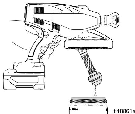
8. Jetez le liquide recueilli dans le réservoir intégré.
