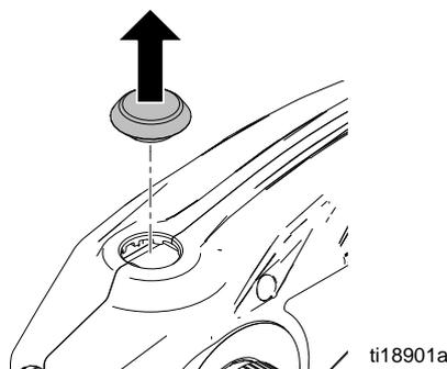
4. Utilisez l'outil (fourni) pour desserrer et retirer le raccord de la soupape d'échappement. Assurez-vous que l'ancien joint torique, l'appui, le raccord de la soupape d'échappement et le ressort sont hors de la cavité d'échappement de la pompe.
