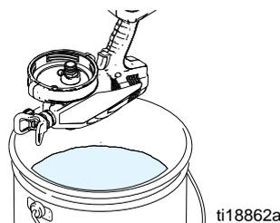
4. Insérez la tuyère du Pump Armor dans l'entrée de produit et appuyez fermement jusqu'à ce que cela bloque. Pressez la bouteille de nettoyant liquide jusqu'à ce que le Pump Armor sorte du tuyau de vidange.
