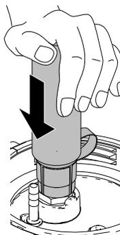
2. Nettoyez les événements ou la soupape de ventilation, en fonction du modèle. Consultez la partie **Arrêt et nettoyage**, page 16.
