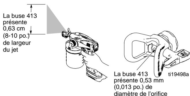
Les deux derniers chiffres = diamètre d'orifice de la buse en millièmes de pouce
