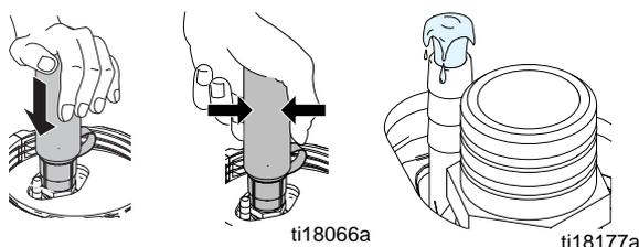
5. Retirez la tuyère du Pump Armor, remettez le capot de sécurité enfants et serrez fermement pour le stockage.
