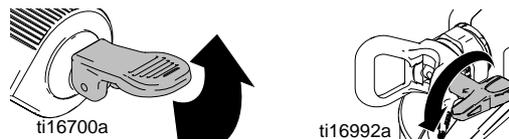
5. Déverrouillez la gâchette, BAISSÉZ la vanne d'amorçage/de pulvérisation en position de pulvérisation et reprenez la pulvérisation.
