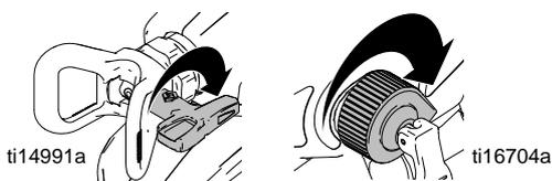
3. Dirigez le pulvérisateur vers une poubelle, déverrouillez la gâchette et BAISSÉZ la vanne d'amorçage/de pulvérisation en position de pulvérisation. Appuyez sur la gâchette pour déboucher la buse.
