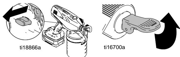
2. Retirez le réservoir de produit intégré et versez le produit en excès dans un récipient adapté. Si elle est usée, jetez la garniture du réservoir de façon appropriée.
