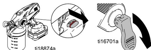
6. Si la buse de pulvérisation est toujours bouchée, vous devrez peut-être répéter les étapes 1 à 5 et basculer à plusieurs reprises la buse de pulvérisation entre les positions PULVÉRISATION et DÉBOUCHAGE. Répétez l'étape 1 pour relâcher la pression, retirez et nettoyez le filtre de la buse de pulvérisation, ou remplacez par un nouvel ensemble buse de pulvérisation/garde.
