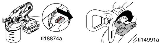
11. BAISSÉZ la vanne d'amorçage/de pulvérisation en position de pulvérisation. Pulvérisez dans une poubelle jusqu'à ce qu'il n'y ait plus de peinture dans l'eau ou le produit de rinçage.
