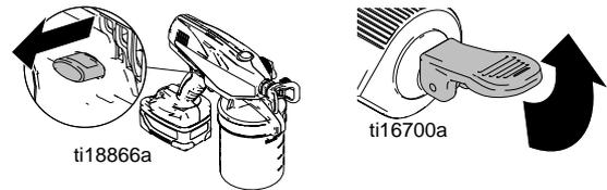
**REMARQUE :** les événements ou la soupape de ventilation (en fonction de l'équipement de votre modèle) permettent à l'air d'entrer dans le réservoir durant la pulvérisation afin d'empêcher toute perte de débit de produit.
