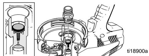
3. Remettez en place le raccord d'admission et utilisez une clé ou une douille pour serrer à 14 N•m (10 pi-lb).
