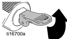
3. BAISSÉZ la vanne d'amorçage/de pulvérisation en position de pulvérisation.
