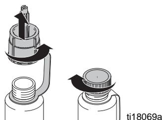
6. Remettez le tuyau d'aspiration souple et le réservoir. BAISSÉZ la vanne en position de pulvérisation.
