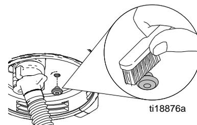
14. Retirez l'ensemble buse/garde et nettoyez-le avec de l'eau ou un produit de rinçage. Au besoin, une brosse douce peut être utilisée pour frotter et retirer tout dépôt de produit ayant séché.
