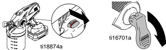
4. Verrouillez la gâchette. LEVEZ la vanne d'amorçage/de pulvérisation pour décompresser et remettez la buse en position PULVÉRISATION.
