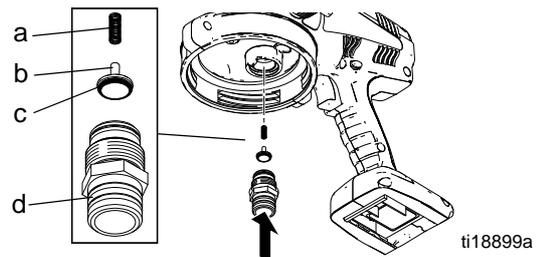
2. Tenez l'admission en place et mettez le pulvérisateur à l'envers. Retirez le raccord de la soupape d'admission et inspectez visuellement pour vérifier que la soupape d'admission est bien à sa place.
