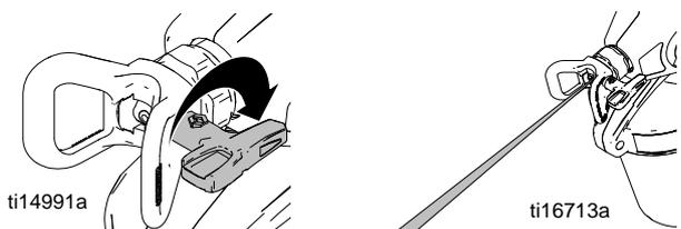
5. Mettez la vanne d'amorçage/pulvérisation en position RELEVÉE pour décompresser. Remettez ensuite la buse de pulvérisation en position de pulvérisation.
