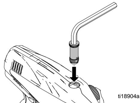
2. Remettez en place le bouchon d'accès au raccord de la soupape d'échappement en appuyant dessus.
