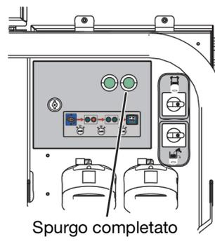
**Per i modelli per zone pericolose**, il sistema si disattiverà se la linea dell'aria è bloccata, disinserita o depressurizzata. Aprire l'interruttore di alimentazione principale (CA) per attivare il sistema e consentire al regolatore di spurgo di completare la sequenza di spurgo di 3 minuti.
