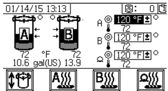
Ajuste todas las temperaturas según las especificaciones de la hoja de datos de sus materiales.
