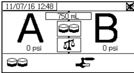
**NOTA:** Estas instrucciones indican el funcionamiento del sistema con control de la relación de mezcla por peso, que es estándar y el preferido para sistemas XM PFP. Para controlar la relación de mezcla por volumen, consulte las **Pantallas de prueba** (página 77).
