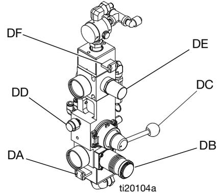
Fig. 37: Controles de aire de la bomba de alimentación
