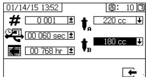
Utilice esta pantalla para establecer el número de pulverizador si se utilizan varios, y para configurar el número de horas descargadas en la unidad flash USB externa y la regularidad a la que se registrarán los datos.
