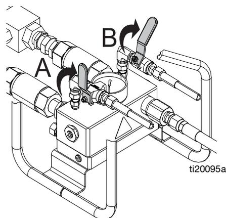
8. Cierre las válvulas de bola del colector de mezcla.
