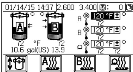
Utilice estas pantallas para activar y desactivar el llenado automático de los tanques, activar y desactivar los calentadores de fluido y el calentamiento de las mangueras, y cambiar los puntos de ajuste de la temperatura para cada calentador de fluido y para el calentamiento de las mangueras.
