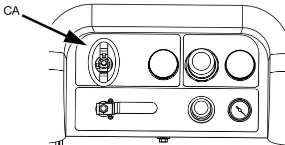
En el caso de modelos para ubicaciones peligrosas, no cierre el interruptor principal (CA). El sistema se apagará si se bloquea el aire, si se desconecta o si se despresuriza. Abra el interruptor principal (CA) para encender el sistema y dejar que el controlador de purga complete la secuencia de purga de 3 minutos.
