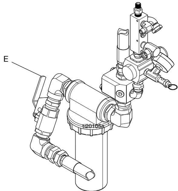
**Requisito del suministro de aire:** 1,0 MPa, 10,3 bar (150 psi) máximo; 552 kPa (5,5 bar, 80 psi) mínimo (mientras esté en funcionamiento).
