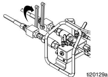
12. Realice el procedimiento de **Evacuación del material mezclado** que empieza en la página 43 para evitar que se seque material mezclado en el sistema y para aliviar la presión de las líneas de limpieza.
