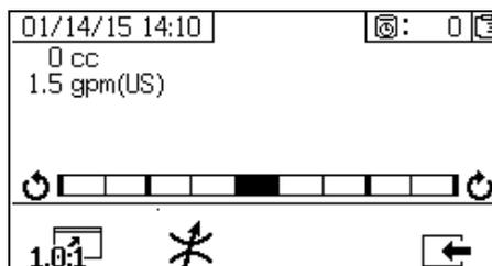
Esta pantalla muestra el equilibrio entre los lados de fluido A y B. Si el gráfico de barras se sitúa a la derecha, significa que no hay suficiente restricción en el lado B, y al aumentar la restricción (manguera de menor diámetro) se reducirá el tamaño de dosificación. Si el gráfico de barras se sitúa a la izquierda, significa que hay demasiada restricción en el lado B. Al reducir la restricción (manguera de mayor diámetro) se reducirá el tamaño de dosificación.
