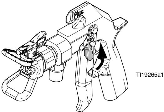
9. Apriete firmemente una parte metálica de la pistola contra un cubo metálico conectado a tierra. Dispare para aliviar la presión en las mangueras de material. Use una tapa de cubo con un orificio para dispensar a través de esta. Selle alrededor del agujero y la pistola con un trapo para evitar salpicaduras.
