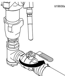
14. En el caso de modelos para ubicaciones no peligrosas: conecte el suministro de aire (CA) y fije el regulador de aire de las bombas dosificadoras a 138 kPa (1,38 bar, 20 psi).
