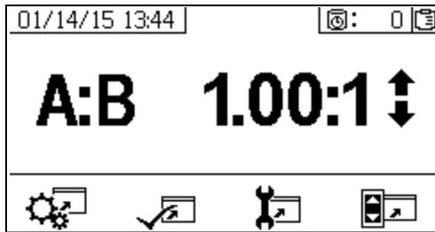
Pantalla principal es la primera pantalla que se muestra en el modo de configuración. Muestra la relación actual de la bomba dosificadora y permite a los usuarios cambiar la relación de mezcla y acceder a las siguientes pantallas: configurar sistema, habilitar/deshabilitar funciones, configurar mantenimiento y límites. Consulte la tabla siguiente para más detalles.
