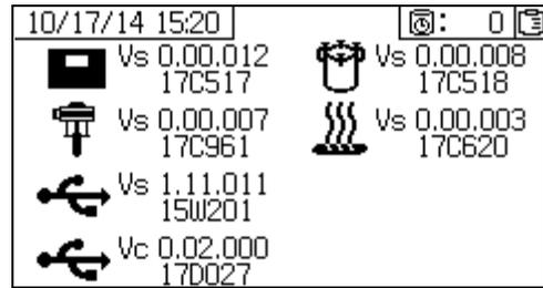
Esta pantalla muestra las versiones y el número de pieza de los componentes del sistema. Consulte la tabla siguiente para los detalles. Para acceder a esta pantalla, pulse en la pantalla de configuración de inicio.
