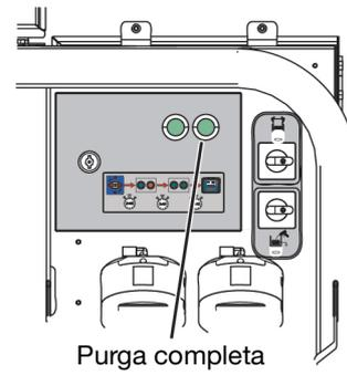
**En el caso de modelos para ubicaciones peligrosas,** el sistema se apagará si se bloquea el aire, si se desconecta o si se despresuriza. Abra el interruptor principal (CA) para encender el sistema y dejar que el controlador de purga complete la secuencia de purga de 3 minutos.
