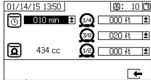
Esta pantalla permite a los usuarios configurar el temporizador de vida útil y la longitud de cada manguera específica del material mezclado. Se calcula el volumen total de material mezclado y se muestra en la página. El tiempo de vida útil se muestra en la esquina superior derecha.
