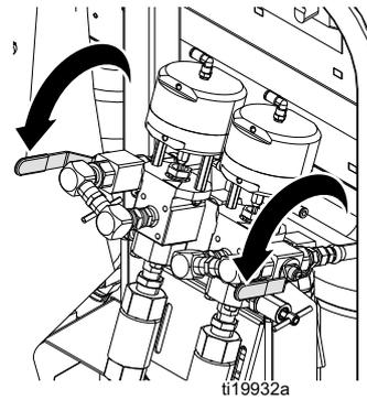
3. Cierre las válvulas de bola de material al colector de mezcla.
