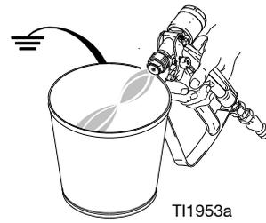
12. Cierre la válvula de aire de la bomba de limpieza (CB) y dispare la pistola en un cubo conectado a tierra para aliviar la presión. Ponga el seguro del gatillo de la pistola.
