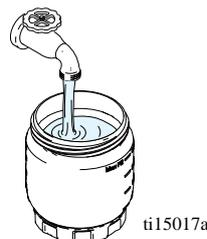
7. Обратно подсоедините бачок для материала и встряхните распылитель, чтобы распределить внутри него воду для очистки всех внутренних поверхностей бачка.
