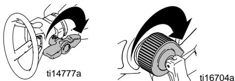
3. Dirigez le pulvérisateur vers une poubelle, déverrouillez la gâchette et BAISSÉZ la vanne d'amorçage/de pulvérisation en position de pulvérisation. Appuyez sur la gâchette pour déboucher la buse.
