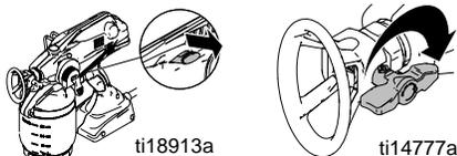
12. BAISSÉZ la vanne d'amorçage/de pulvérisation en position pulvérisation. Pulvérisez dans une poubelle jusqu'à ce qu'il n'y ait plus de peinture dans l'eau ou le produit de rinçage.
